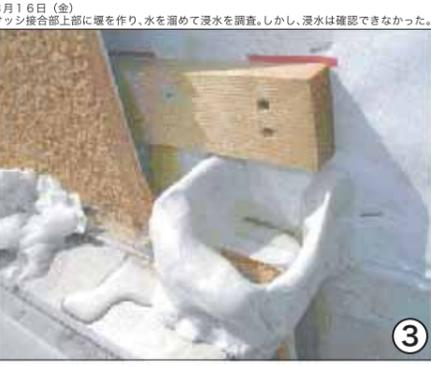
3月16日(金) サッシ接合部上部に板を作り、水を溜めて浸水を調査。しかし、浸水は確認できなかった。
